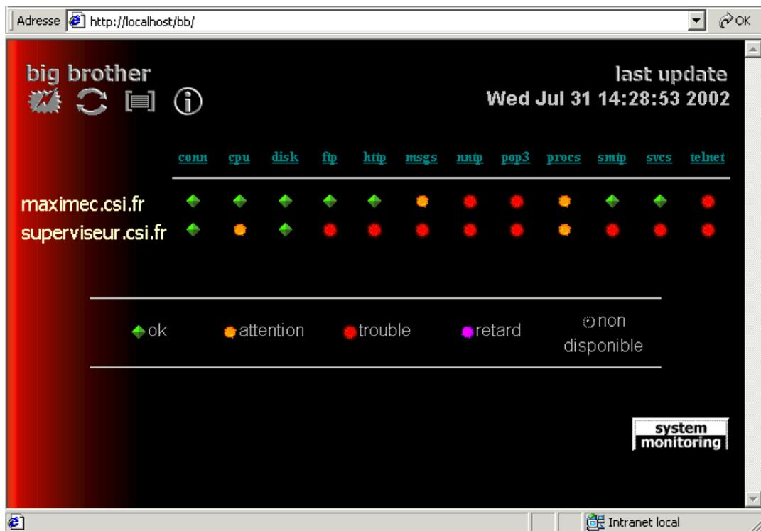
On peut donc superviser différentes fonctions d'un système, qui nécessite différents niveaux de configuration :
